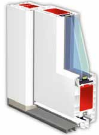
Haustürprofil Modell hilzinger Prestige, System Anschlagdichtung, flächenversetzt mit abgerundeten Konturen und thermisch getrennter Schwelle.
